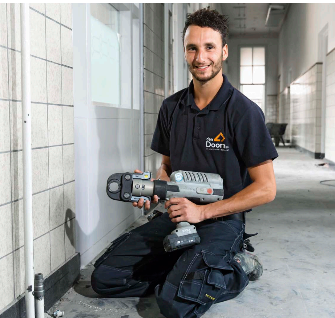
Het lassen van dikwandig stalen buizen behoort met Viega Megapress tot het verleden.
