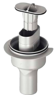
Afvoer, verticaal model voor inbouwhoogten vanaf 40 mm, Afvoercapaciteit: 0,9 – 1,1 l/s, Waterslotheogte: 50 mm (brandveilige buisdoorvoering mogelijk)
