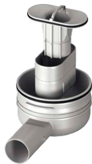
Afvoer voor inbouwhoogten vanaf 95 mm, Afvoercapaciteit: 0,5 – 0,55 l/s, Waterslotheogte: 50 mm (bij renovatie-model inkortbaar)
