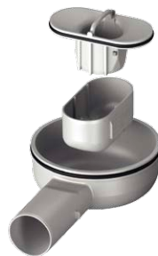
Afvoer renovatiemodel voor inbouwhoogten vanaf 70 mm, Afvoercapaciteit: 0,4 – 0,45 l/s, Waterslotheogte: 25 mm
