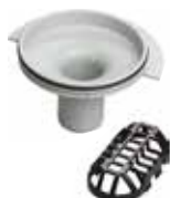
Verticaal model, zonder sifon, met zeefinzetstuk, Afvoercapaciteit: 1,2 l/s Model 4982.83
