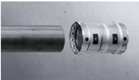
Stalen buis afkorten en reinigen, insteekdiepte markeren en de fitting op de buis plaatsen.
