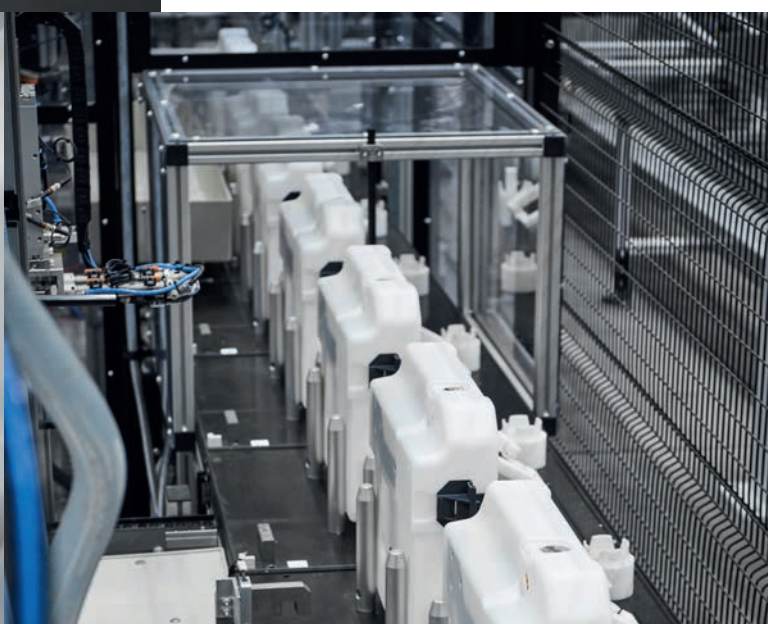
100% betrouwbaar: ieder afzonderlijk inbouwreservoir wordt meerdere malen op dichtheid getest.
