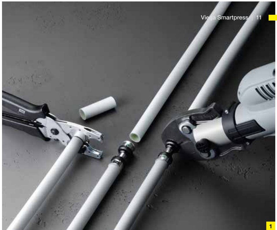
Tijdrovend kalibreren vervalt: eenvoudig afkorten, vaststeken, persen en klaar.
