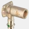
Sanpress muurplaat met SC-Contur - brons of silicium brons - persaansluiting, Rp-draad uitvoering afdichtingselement EPDM, aansluitknie inkortbaar, bevestigingsflens model 2225
