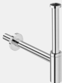
Eleganta bekersifon - messing verchroomd uitvoering verstelbuis 200 mm, afvoerbuis 310 mm, rozet Ø32xØ80xH15 mm model 5788
