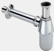
Bekersifon - messing verchromd uitvoering beker Ø 60 mm, rozet, verstelbuis 95 mm, afvoerbuis 200 mm gecontroleerde kwaliteit volgens NEN EN 274 model 5763
