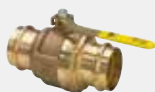
Profipress G gaskogelkraan met SC-Contur - persaanluitingen - afsluitbaar uitvoering behuizing brons, afdichtingselementen HNBR Technische gegevens HTB (hoger thermisch belastbaar) 650 °C/30 min GT1 bedrijfsdruk max. 0,5 MPa (MOP 5) met DIN-DVGW-G-keurmerk model 2670
