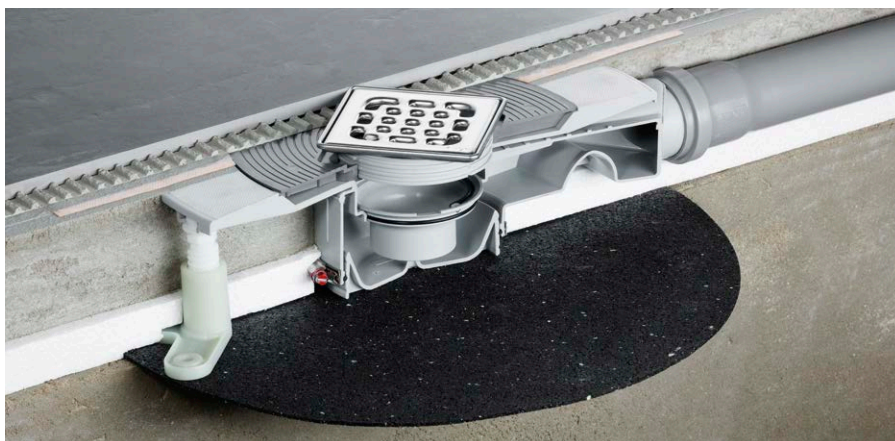
Advantix Top-afvoer beveiligd tegen terugzuiging door waterslotbarrière met doorloopopening in het midden en waterbuffers aan de zijkant.
