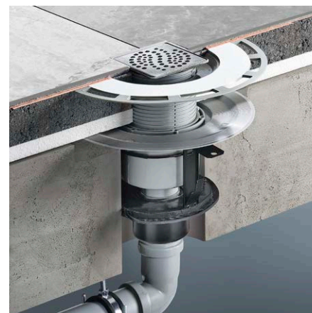
Brandwerende afvoer R 120, verticale afvoerinstallatie voor vlakke opbouwhoogten en gebruik in de dunbedafdichting.
